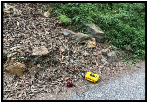
รูปที่ 2-8 การตรวจวัดความสั่นสะเทือนรอบประทานบัตร
