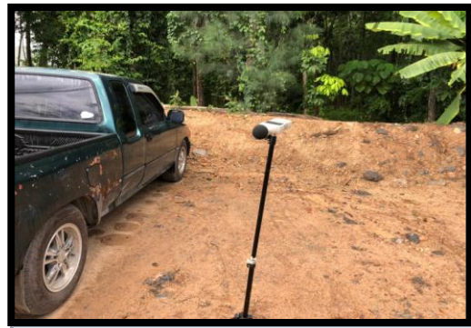
รูปที่ 2-4 การตรวจวัดคุณภาพอากาศ และเสียง บริเวณโรงโม่หิน
