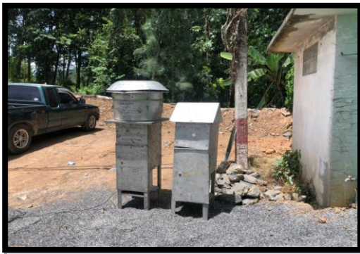
รูปที่ 2-4 การตรวจวัดคุณภาพอากาศ และเสียง บริเวณโรงโม่หิน
